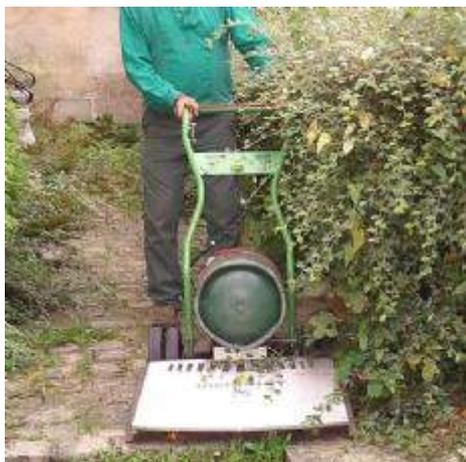
sécurités (poignée homme-mort, soupape de sécurité...), elle se manie très facilement et se met en marche d'une simple pression sur le bouton de la batterie.
